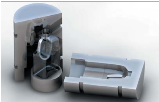
Rys. 1. Butelka wraz z wkładkami formy poddana realistycznemu renderingowi
