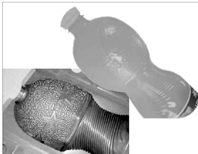
Rys. 5. Przykład wykorzystania środowiska Delcam Power Solutions do zaprojektowania modelu 3D oraz procesu wytwarzania matrycy formy rozdmuchowej do butelek PET
