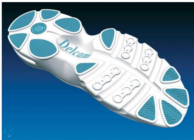
Modelowanie hybrydowe jest przydatne przy konstruowaniu powierzchni o trudnej geometrii np. bieżnik podeszwy obuwia
