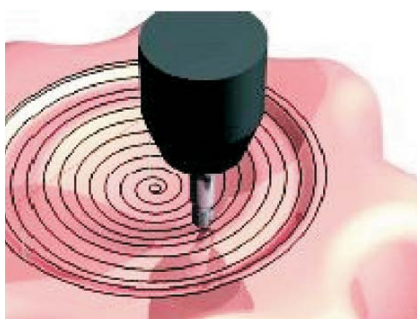
Rys. 3. Frezowanie z opcją SPIRAL dla obszaru kołowego
